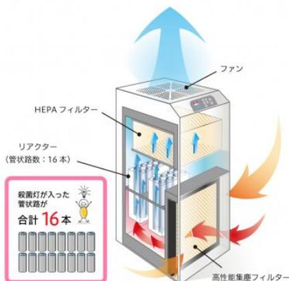
こちらの装置は吹き出し口が上面になっており、使用用途としては『設置周囲の環境を清浄化する』目的で使用するものです。
